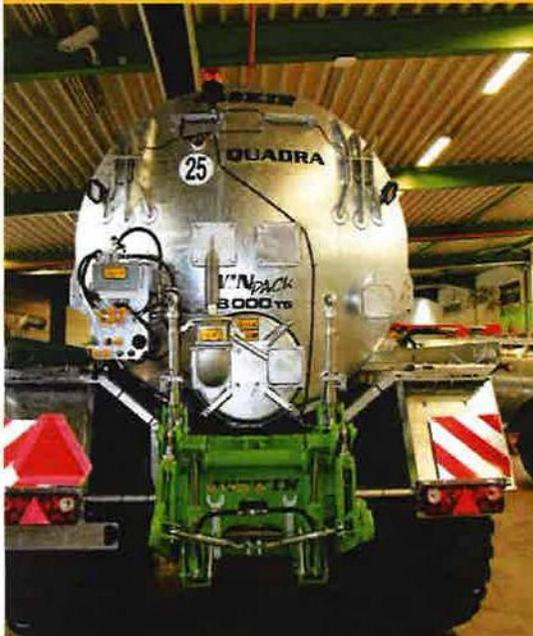
Le relevage 4-points arrière et les points de montage au sommet de la cuve sont des pré-équipements pour un outil arrière, comme une rampe à pendillards
