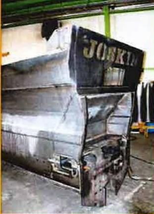
Un châssis Euroliner est équipé avant que la cuve n'y soit montée
